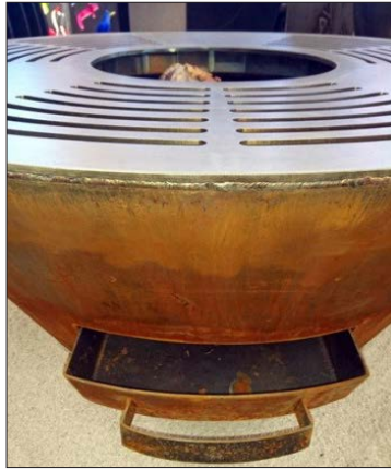
Grillring fix mit Schale verschweisst
